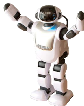
図3-2. コミュニケーション ロボット PALRO 全高約40cm、重量約1.8kg
